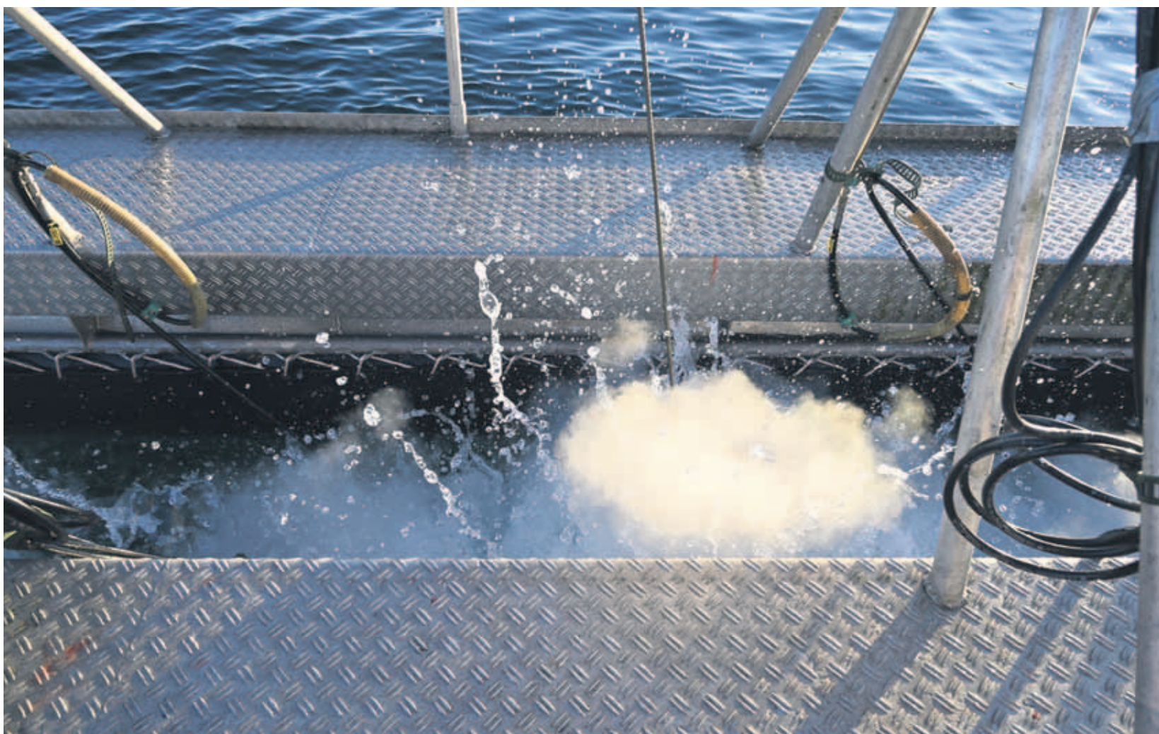
Le canon émet des ondes que les hydrophones enregistrent.
