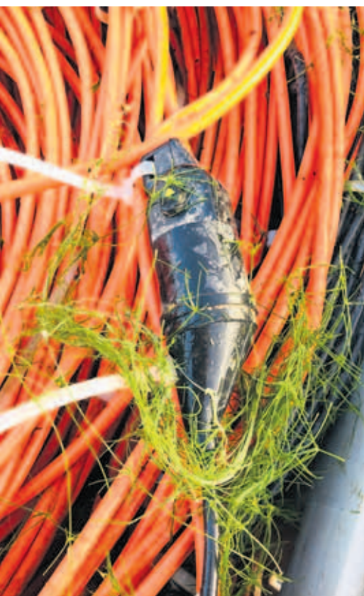
Un hydrophone en gros plan au sortir de l'eau après un mois d'écoute posé au fond du lac.
